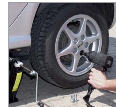
Atornillado por percusión: cambio rápido de ruedas
